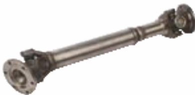
■ P.T.O SHAFT L:72CM D.F:10CM (6HOLE)
